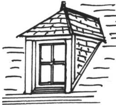
La lucarne à capucine Avec trois pans de couvertures
